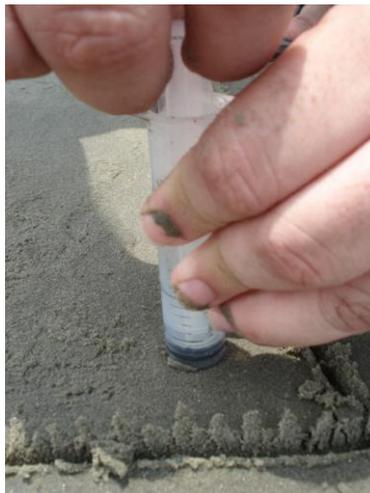
Figura 5- Detalhe as coleta de sedimento.
