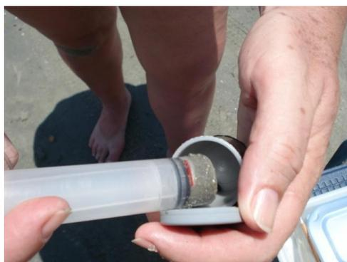
Figura 6 – Detalhe do core PVC, com 1 cm de sedimento.
